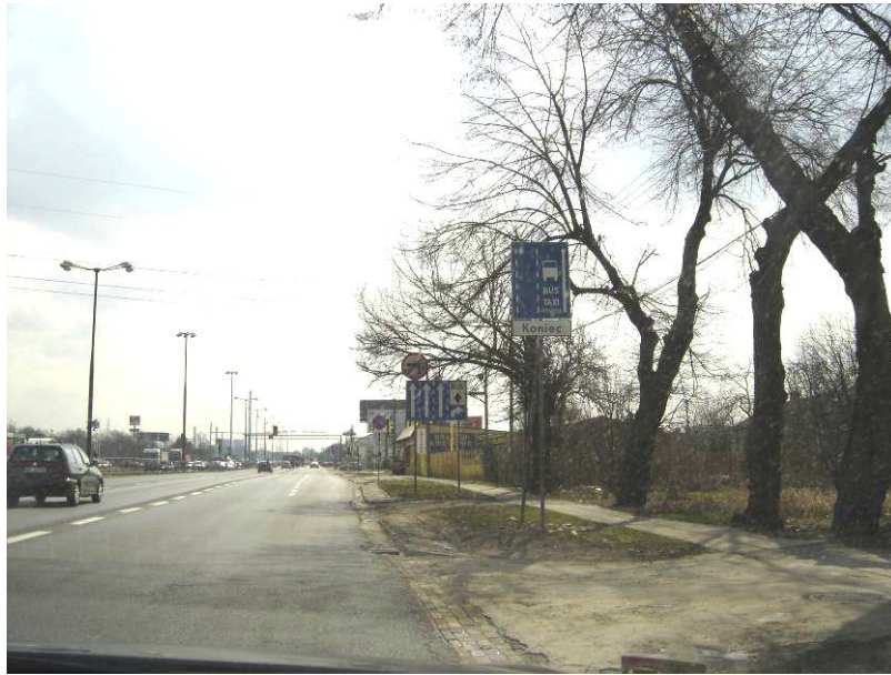
Fot. 1. Ul. Modlińska, pionowy znak D-12 wraz z tabliczką KONIEC, błędnie informującą o końcu pasa autobusowego.
