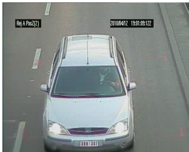
Rys. 29. Przykład zagranicznej tablicy rejestracyjnej. Tablica została poprawnie odczytana i zaklasyfikowana jako europejska tablica rejestracyjna
