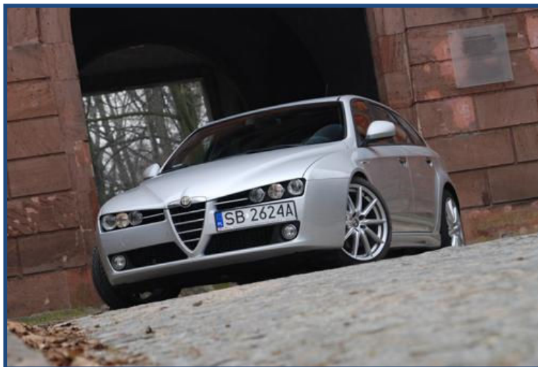
Rys. 2. Niestandardowe miejsce montażu tablicy rejestracyjnej utrudniające rozpoznanie numerów rejestracyjnych – przypadek samochodu Alfa Romeo 159
