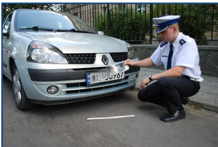
Rys. 1. Fotografia nakładki utrudniającej rozpoznanie numeru rejestracyjnego
