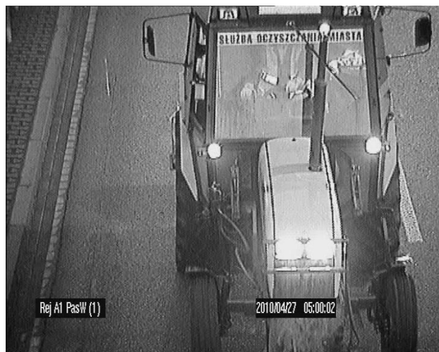
Rys. 27. Przykład pojazdu niestandardowego. System ARTR odczytał „Służba ocz” jako numer rejestracyjny i zaklasyfikował rozpoznany napis jako zagraniczną tablicę rejestracyjną
