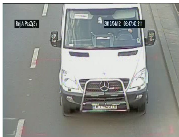
Rys. 30. Przykład tablicy rejestracyjnej zasłoniętej przez element nadwozia. Tablica niepoprawnie odczytana
