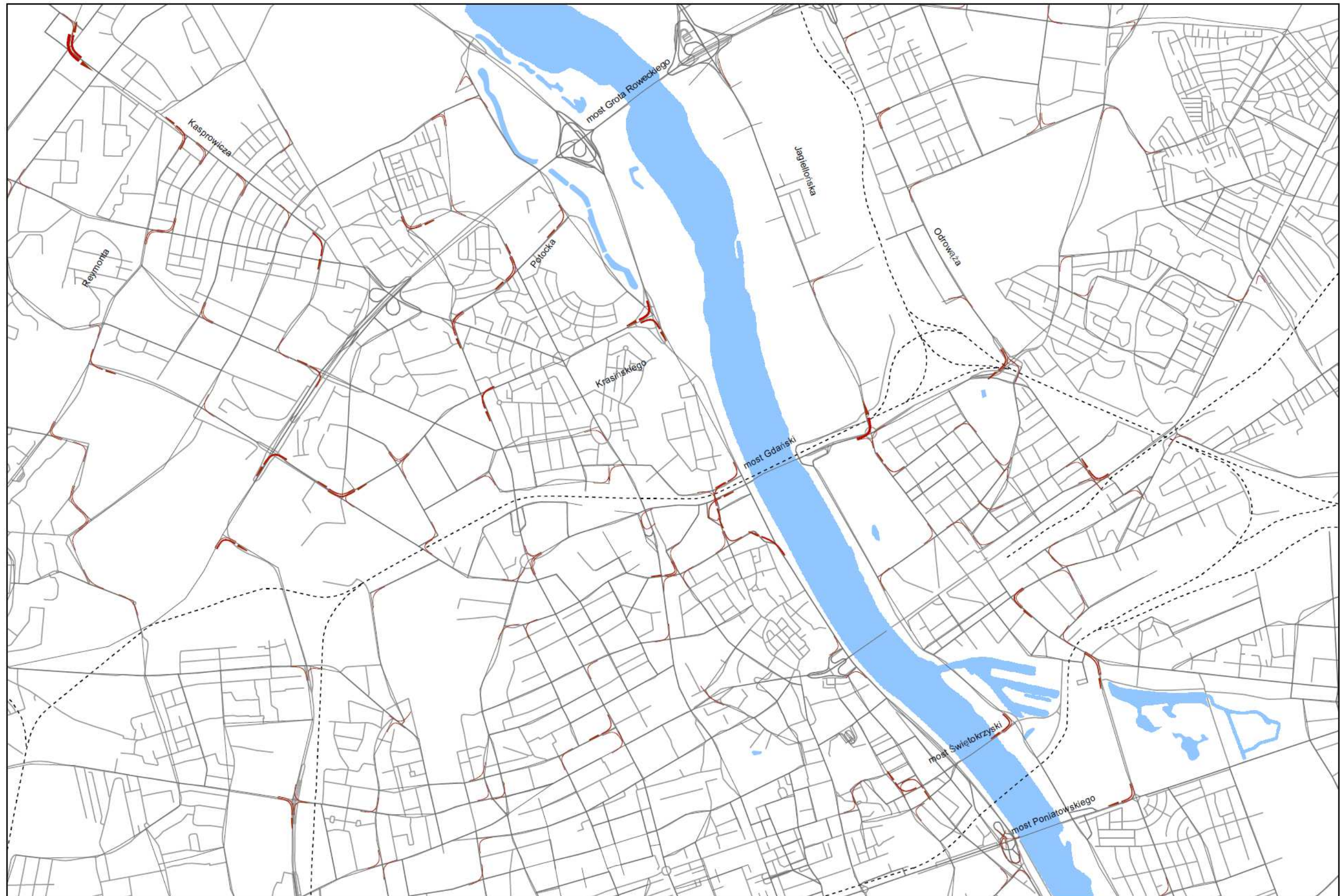
W2.E2.POR Rys. 4.114 Przyrost ruchu na relacjach skrętnych na skrzyżowaniach, w wyniku funkcjonowania tymczasowej organizacji ruchu na czas przebudowy Trasy S8, na odcinku węzeł Powązkowska – węzeł Modlińska, wariant 2, etap 2, rok 2013-2014 (szczyt poranny).
