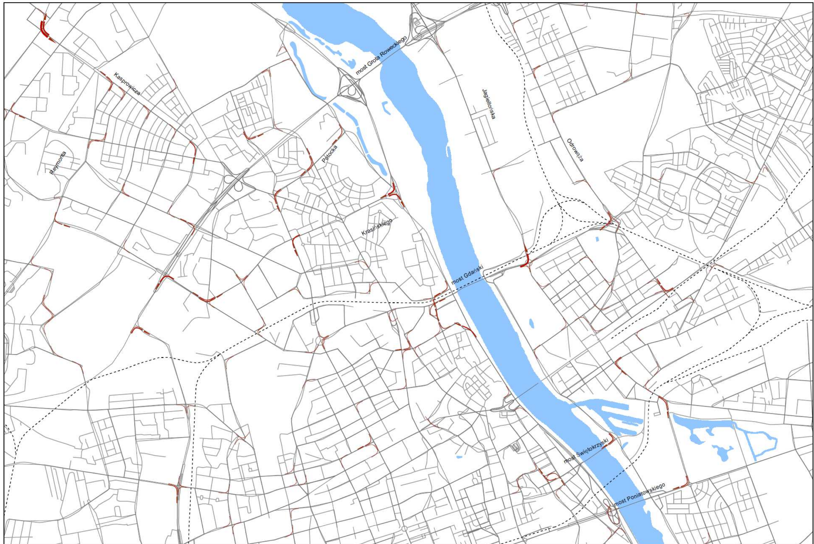
W1.E2.POR Rys. 4.46 Przyrost ruchu na relacjach skrętnych na skrzyżowaniach, w wyniku funkcjonowania tymczasowej organizacji ruchu na czas przebudowy Trasy S8, na odcinku węzeł Powązkowska – węzeł Modlińska, wariant 1, etap 2, rok 2013-2014 (szczyt poranny).
