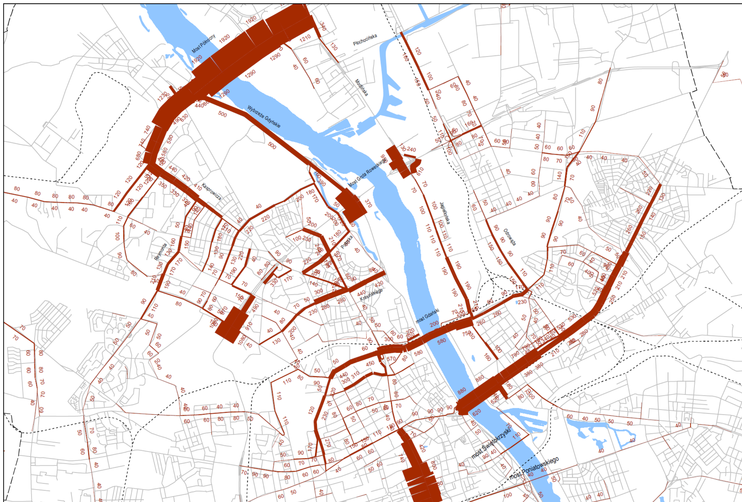
W4.E1.POR Rys. 6.34 Prognoza natężenia ruchu przekierowanego, w związku z wprowadzonymi zmianami w organizacji ruchu i ograniczeniami przepustowości Trasy S8, na odcinku węzeł Powązkowska – węzeł Modlińska, wariant 4, etap 1 - rok 2013-2014 (pojazdy/godzinę szczytu porannego).
