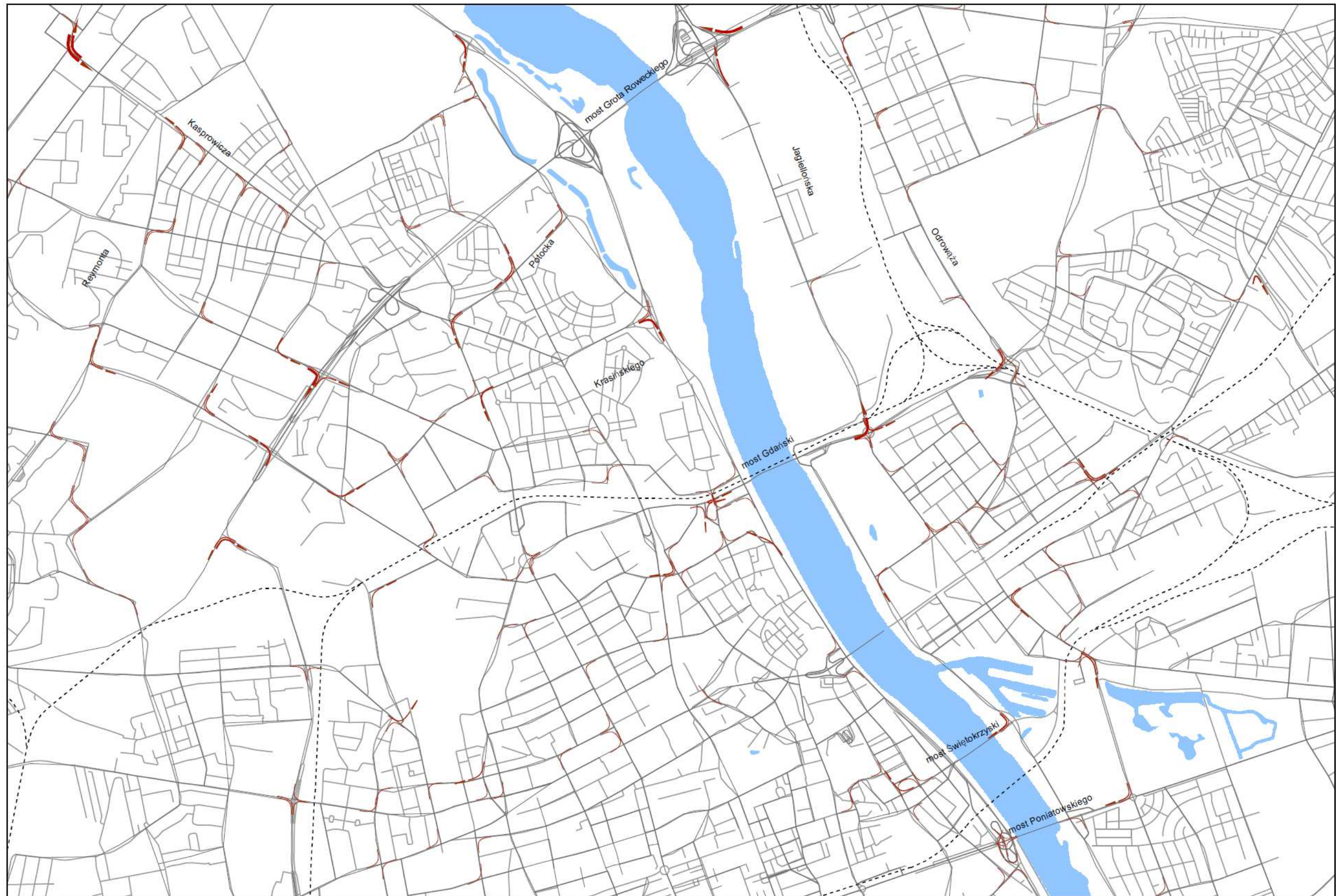
W1.E1.POR Rys. 4.22 Przyrost ruchu na relacjach skrętnych na skrzyżowaniach, w wyniku funkcjonowania tymczasowej organizacji ruchu na czas przebudowy Trasy S8, na odcinku węzeł Powązkowska – węzeł Modlińska, wariant 1, etap 1, rok 2013-2014 (szczyt poranny).
