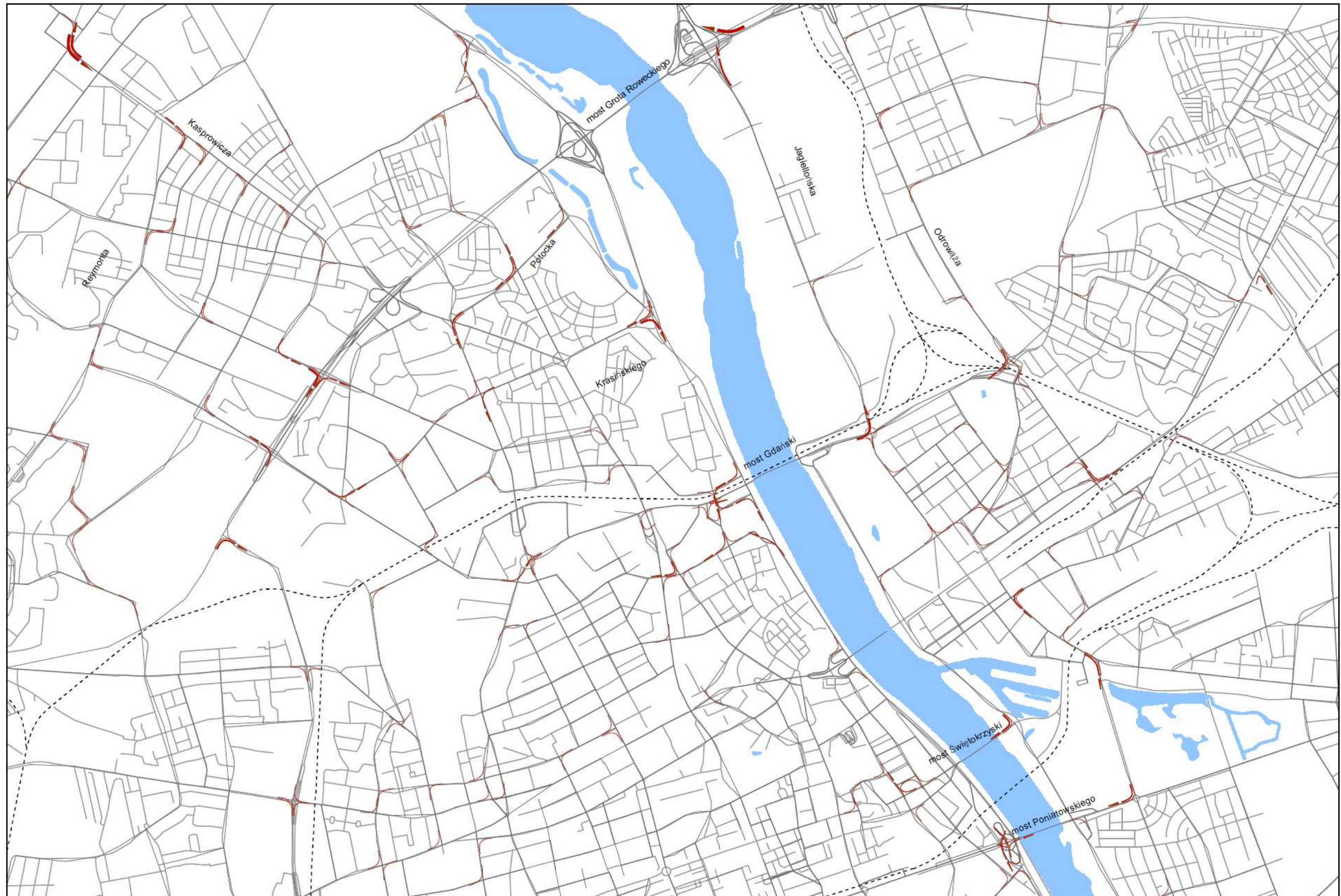
W2.E1.POR Rys. 4.90 Przyrost ruchu na relacjach skrętnych na skrzyżowaniach, w wyniku funkcjonowania tymczasowej organizacji ruchu na czas przebudowy Trasy S8, na odcinku węzeł Powązkowska – węzeł Modlińska, wariant 2, etap 1, rok 2013-2014 (szczyt poranny).
